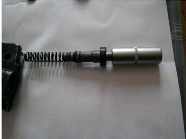
Sitzt der Dichtring in seiner Endposition, wird er durch den Sicherungsring fixiert.
