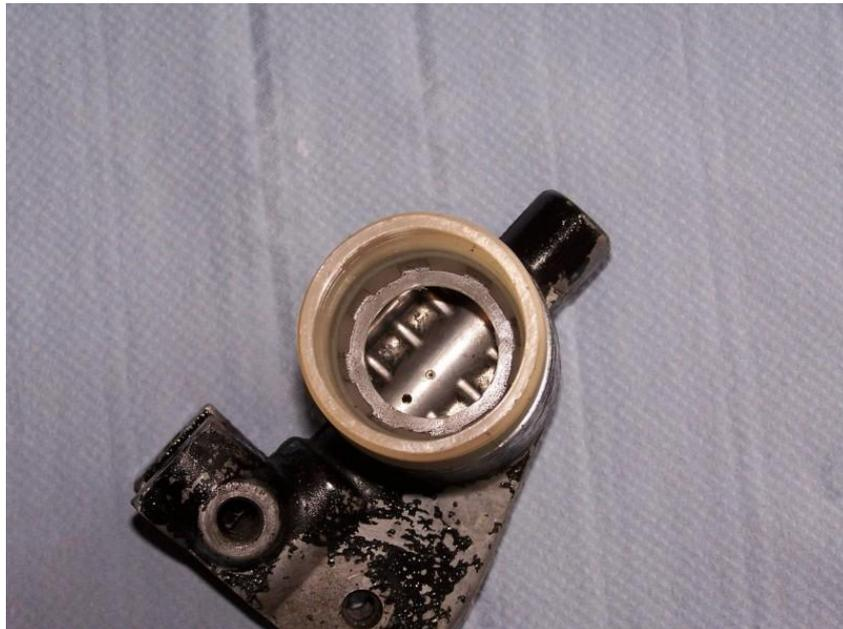
Mangelnde Pflege, uralte Bremsflüssigkeit und Undichtigkeiten lassen die Teile so richtig schön versiffen. Innen wie auch Außen. Ich bin faul und lege die Teile paar Tage in Diesel. Kontakt 60 Spray entfernt sehr gut Metaloxide und kann für die schnellere Methode verwendet werden. Wichtig bei der Reinigung sind die Dichtflächen und der Bremszylinder an sich. Was oft übersehen wird sind diese zwei Bohrungen.
