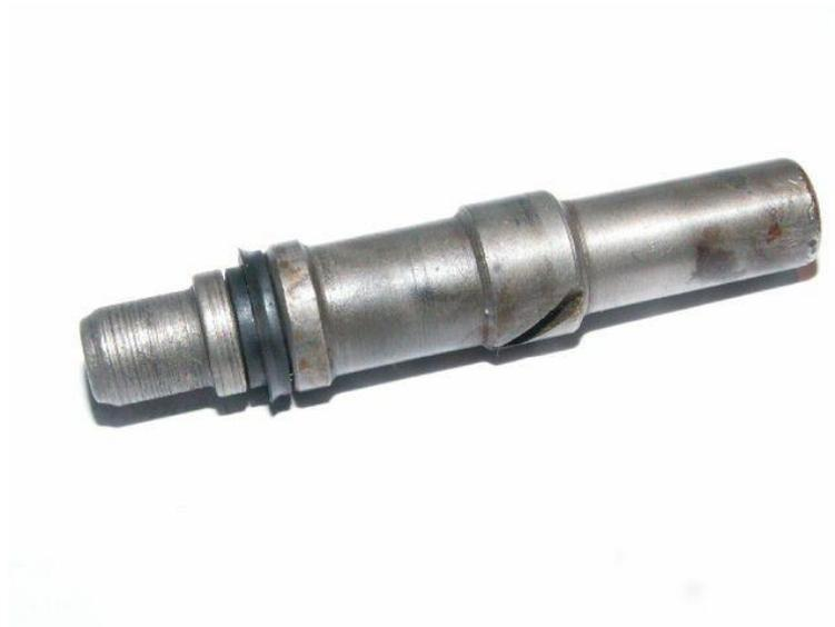
Danach die Feder einfügen, um im Anschluss den großen Wellendichtring (offene Seite nach links- also zum Inneren der Bremspumpe) samt Bremskolben einzusetzen.
